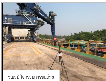
ภาพที่ 3.75 การตรวจวัดปริมาณฝุ่นในสถานที่ทำงาน (TD)
